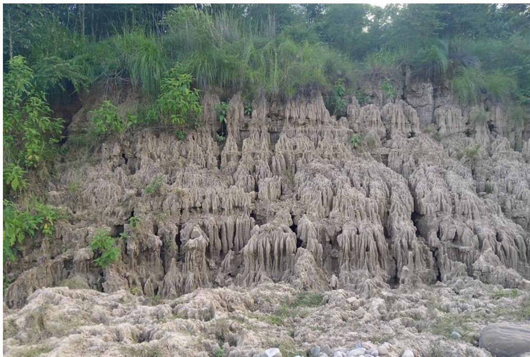
फोटो नं. ३: Counter berm निर्माणको लागि प्रस्ताव गरिएको स्थलमा रहेको घुलनशील माटो
